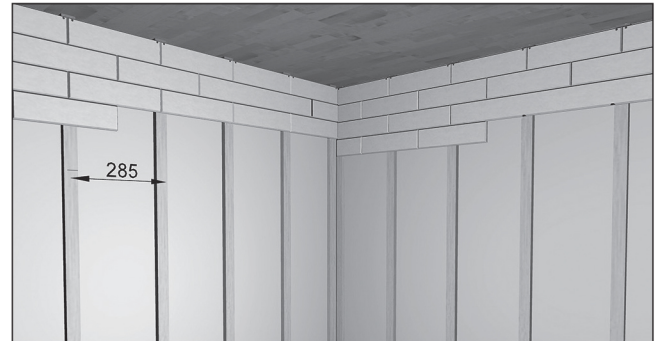
Joonis 3. Horisontaalse voodrilaua paigaldus (laua pikkus 293 mm).
