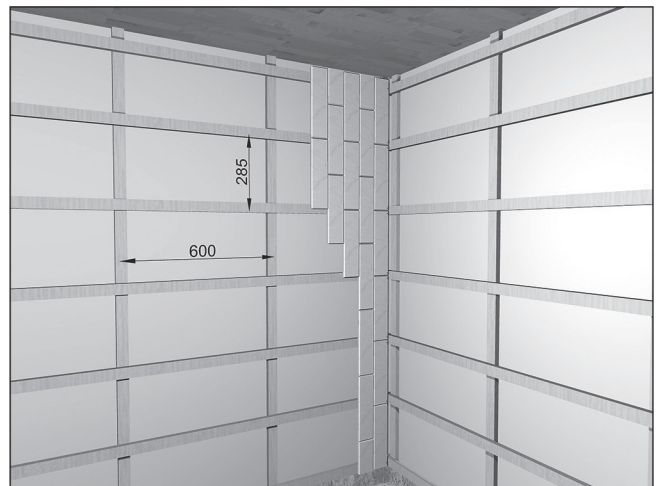
Joonis 4. Vertikaalse voodrilaua paigaldus kahekordse distantsliistu puhul (laua pikkus 293 mm).
