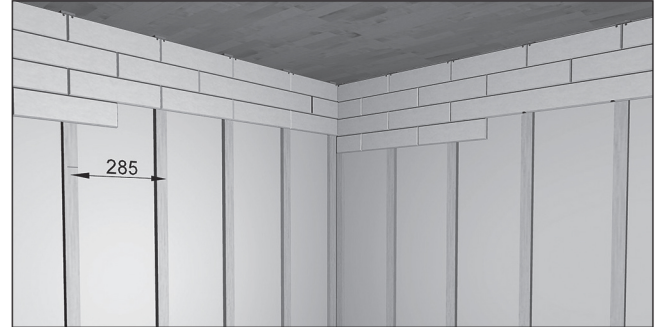
Kuva 3. Vaakasuoran verholaudan asennus (laudan pituus 293 mm).
